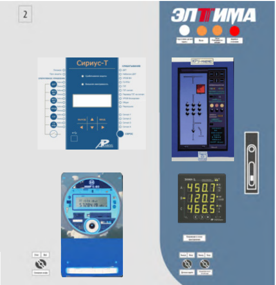
Рис. 10. Шкаф ввода с МП РЗА, многофункциональным счётчиком энергии, модулем индикации мнемосхем и светодиодным модулем индикации
