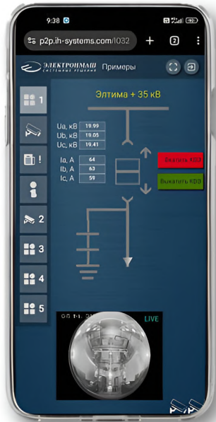
Рис. 21. Экран системы мобильного контроля и управления КРУ
