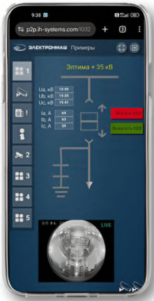
Рис. 21. Экран системы мобильного контроля и управления КРУ
