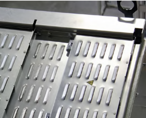
Рис. 13. Клапаны сброса давления
