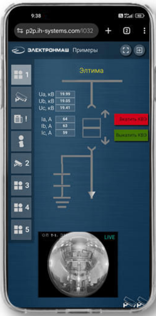
Рис. 38. Экран системы мобильного контроля и управления КРУ
